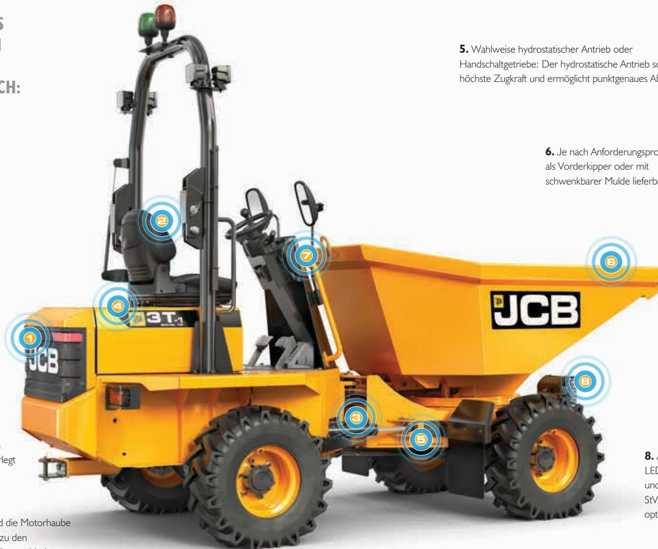
**5.** Wahlweise hydrostatischer Antrieb oder Handschaltgetriebe: Der hydrostatische Antrieb sorgt für höchste Zugkraft und ermöglicht punktgenaues Abladen.
