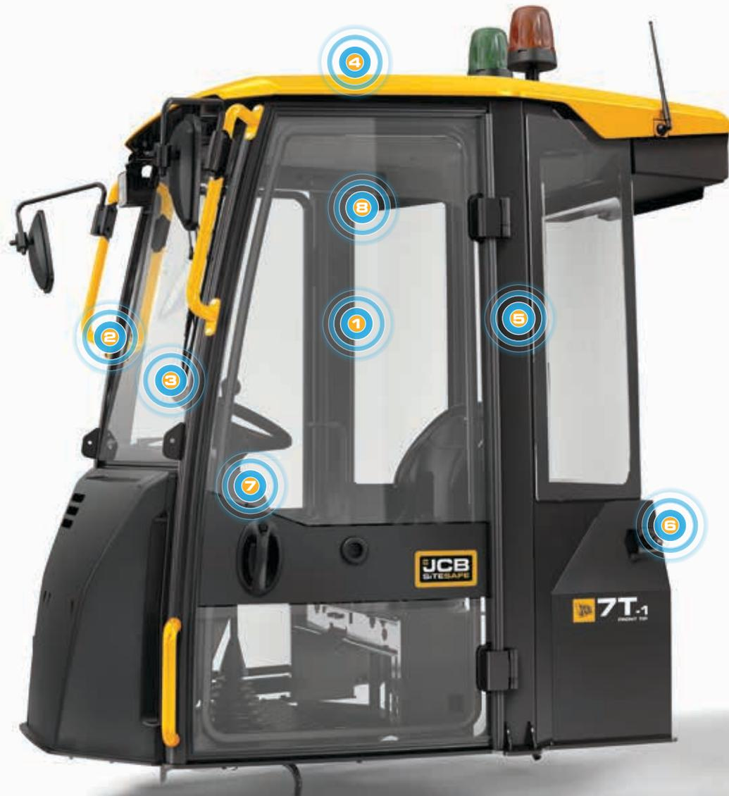
4. Für Wartung und Transport abnehmbar. Bei Montage an Kippern mit sechs und sieben Tonnen Gesamtgewicht liegt die Höhe über alles unter drei Metern.
