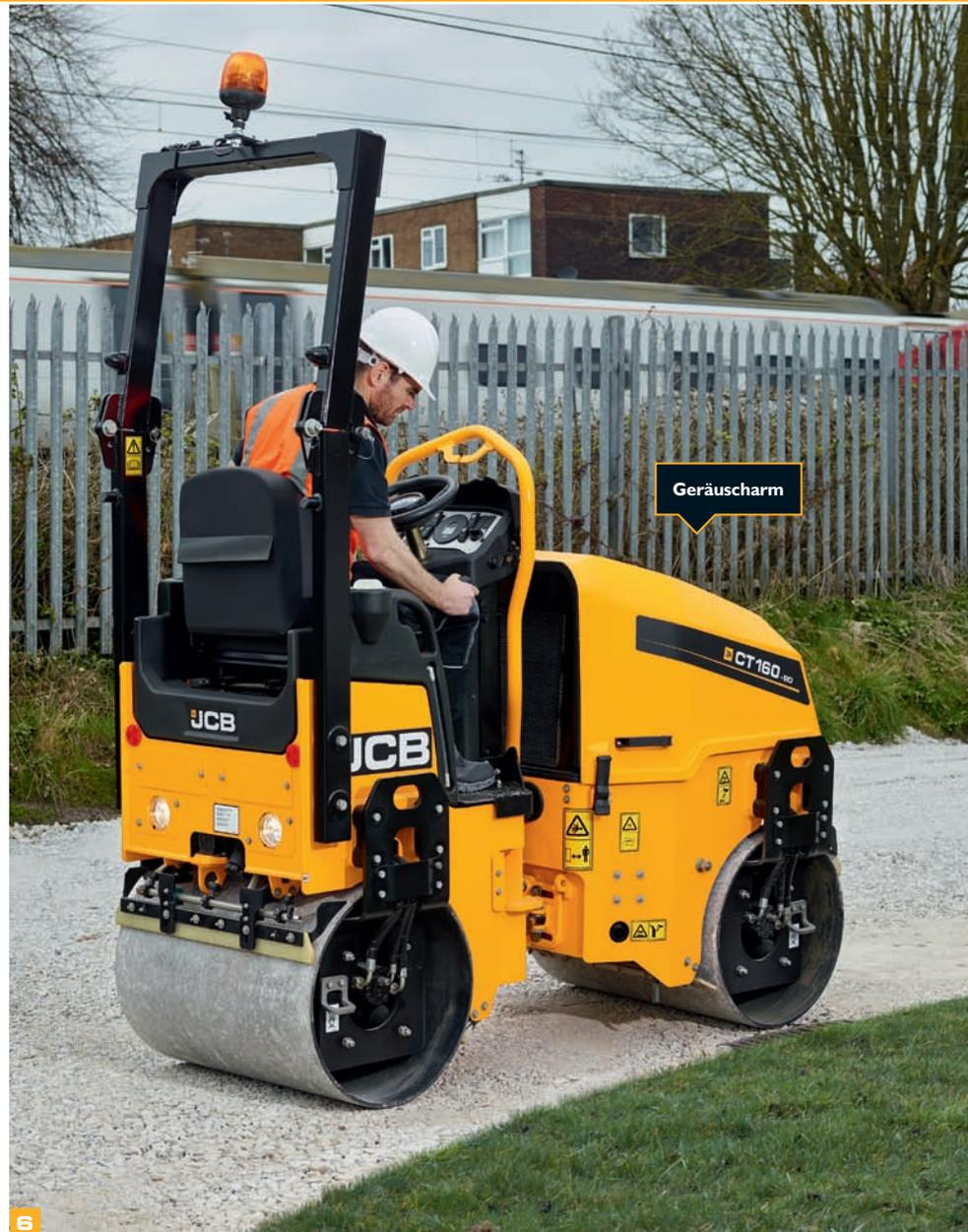
**6** Die CT160 und CT260 verfügen über drei einfache, schaltbare Vibrationseinstellungen: für beide Walzen, unabhängig ob vorn oder hinten. Serienmäßige automatische Vibrationssteuerung.
