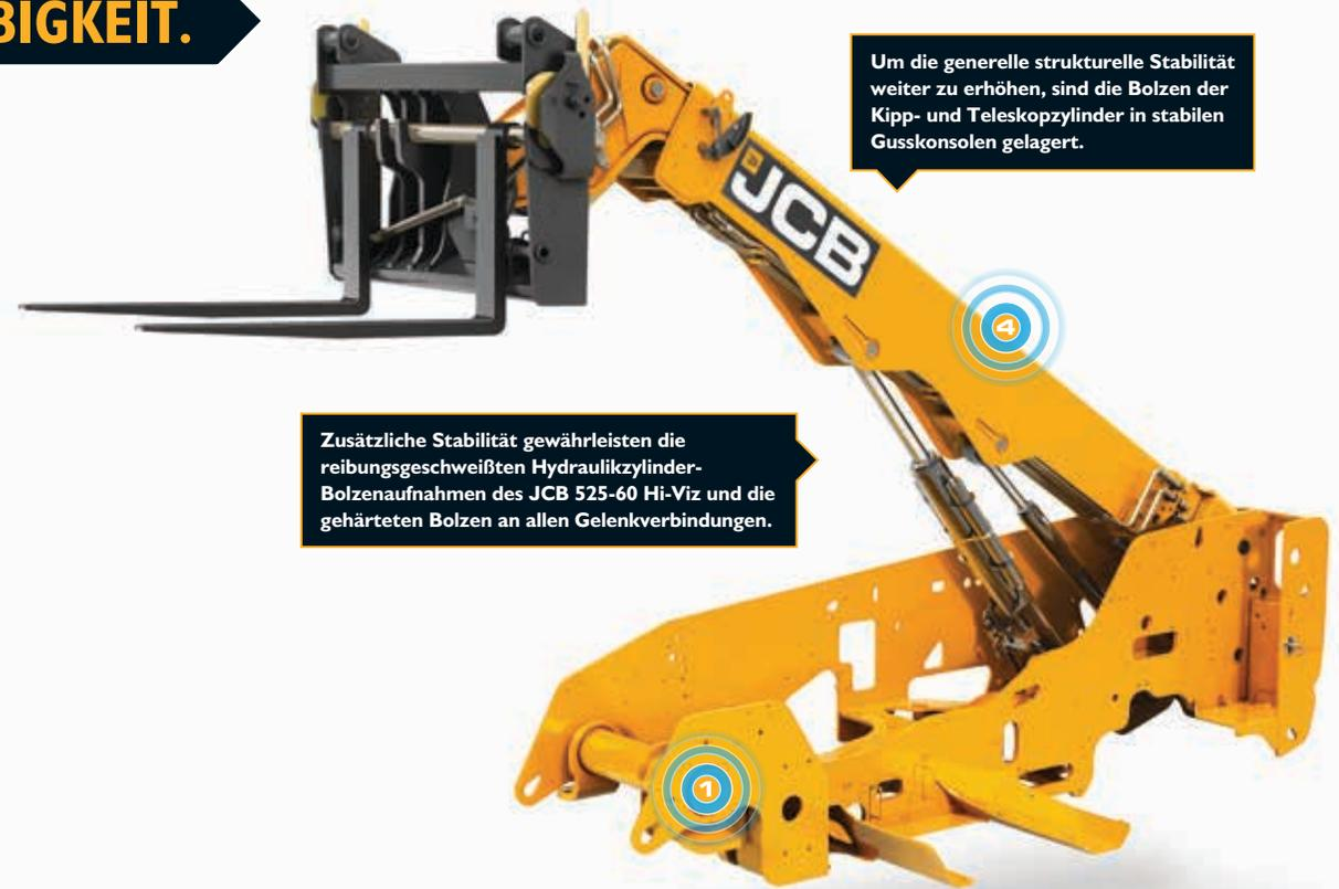
Um die generelle strukturelle Stabilität weiter zu erhöhen, sind die Bolzen der Kipp- und Teleskopzylinder in stabilen Gusskonsolen gelagert.
