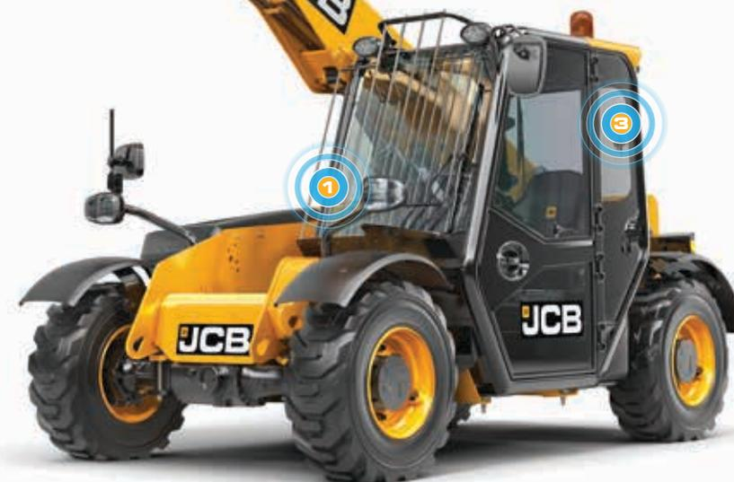
**e** Die Bedienung eines JCB 525-60 Hi-Viz ist komfortabel, präzise und einfach: Sie erfolgt über die elektrische Einhebel-Servosteuerung mit proportionalen Zusatzkreisen.
