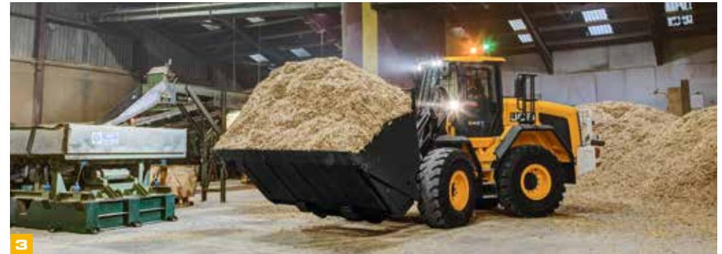
4 Wählen Sie das optimale Hubgerüst für Ihren Einsatz: Die Z-Kinematik (ZX) ermöglicht hohe Ausbrechkraft, während sich die HT- Bauform für Parallelhub und flexible sowie übersichtliche Nutzung der Anbaugeräte eignet.
