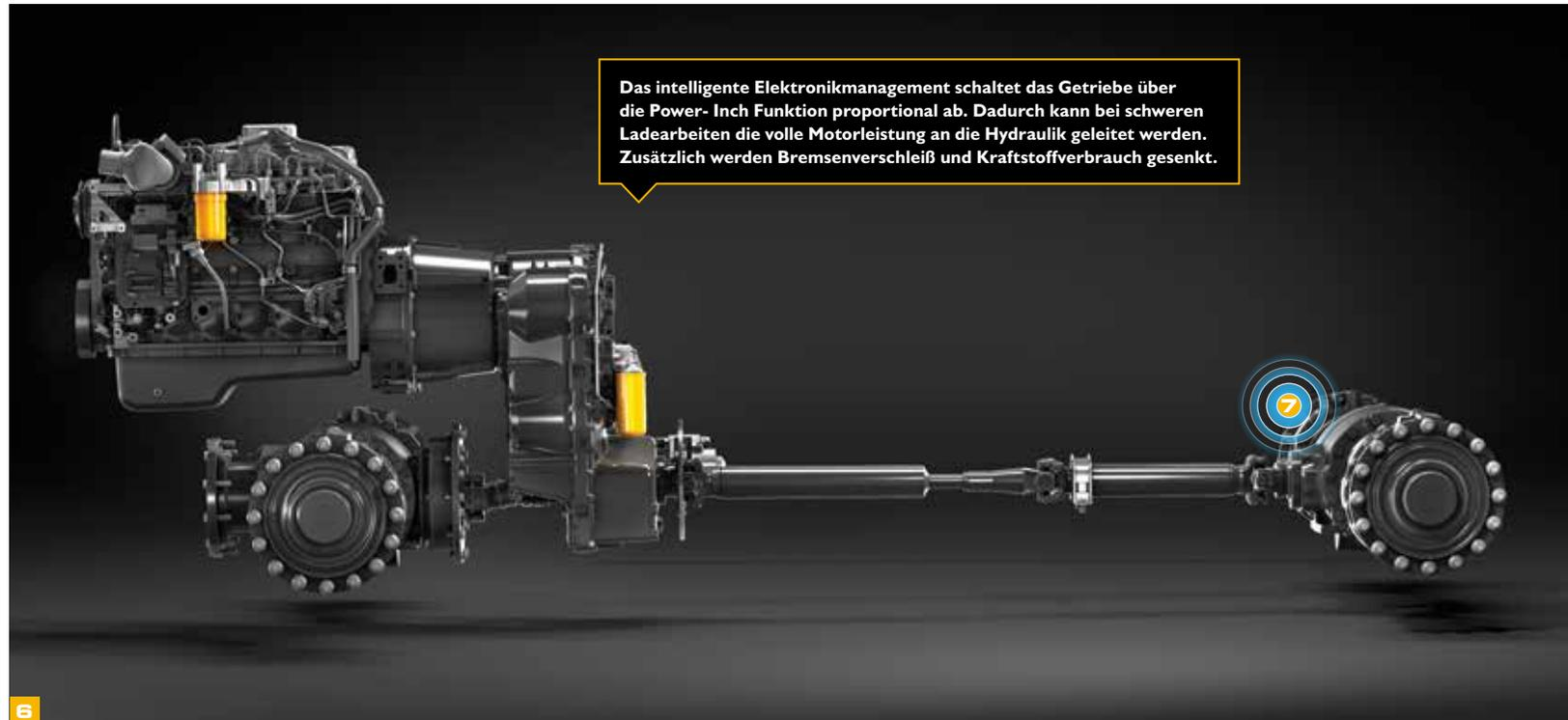
Das intelligente Elektronikmanagement schaltet das Getriebe über die Power- Inch Funktion proportional ab. Dadurch kann bei schweren Ladearbeiten die volle Motorleistung an die Hydraulik geleitet werden. Zusätzlich werden Bremsenverschleiß und Kraftstoffverbrauch gesenkt.
