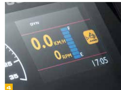
Die neue Funktion „Automatische Motorabschaltung“ spart Kraftstoff, da sie den Motor abschaltet, wenn sich die Maschine länger im Leerlauf befindet. Die Leerlaufzeit kann der Bediener aus einstellen.
