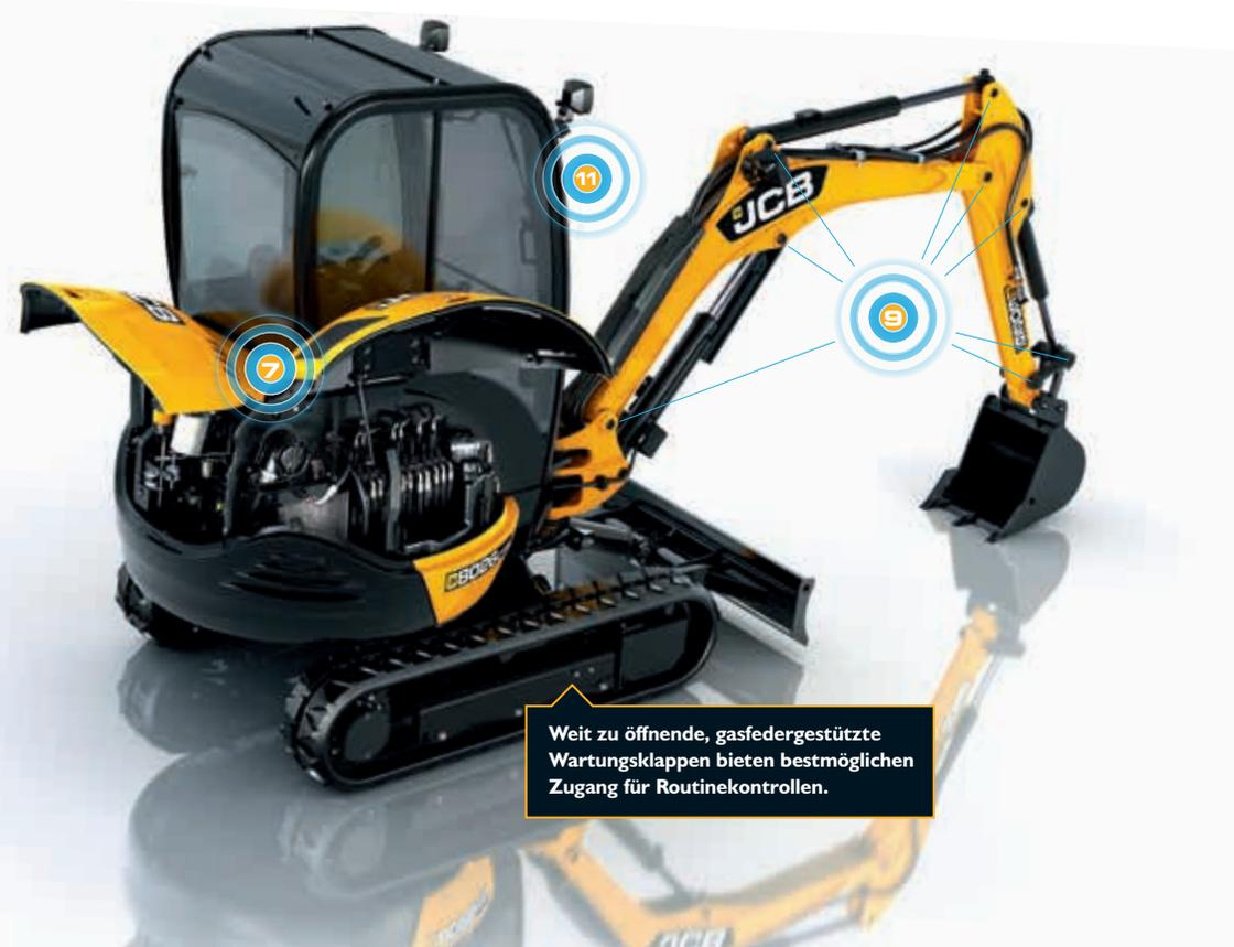
Weit zu öffnende, gasfedergestützte Wartungsklappen bieten bestmöglichen Zugang für Routinekontrollen.
