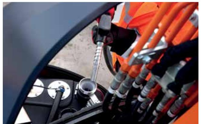
Der Kraftstofftank wurde ebenfalls neu positioniert, um das Nachfüllen einfacher und sicherer zu machen.
