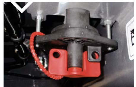
LOG OUT TAG OUT BATTERIETRENNNSCHALTER
