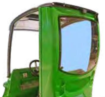
Direkt am ROPS-Überrollbügel kann optional eine Rückwand mit Fenster montiert werden, die vor Wind und leichtem Regen schützt. Die Rückwand erfordert einen 50 mm höheren ROPS-Überrollbügel an Ladern der 500, R- und e-Serie.
