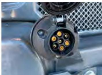
Die 7-polige Anhängersteckdose wird an der hinteren Stoßstange des Laders montiert. Diese ist nur in Verbindung mit dem Kommunalpaket (Option) verfügbar. Die Standards für Anhängersteckdosen variieren in verschiedenen Ländern, wenden Sie sich bitte an Ihren örtlichen Avant-Händler.
