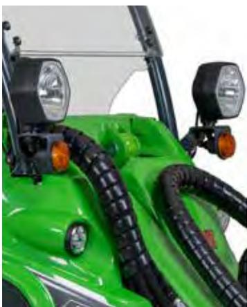
Das Paket beinhaltet Scheinwerfer, Blinker, Rundumleuchte, Reflektoren, einen Spiegel und das Warndreieck im Heck der Maschine. Das Kommunalpaket ist normalerweise eine Voraussetzung zur Erteilung einer Straßenzulassung, bitten nehmen Sie Kontakt mit Ihrem Avant-Händler auf. Im Kommunalpaket für die 400-800er Serie ist neben der Rundum-Kennleuchte auch eine Rückwand enthalten.
